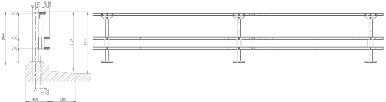
Barrière d'ouvrage d'art (supports tous les 3 mètres) à utiliser dans les zones de circulation
