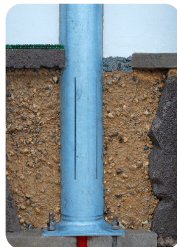
Masten og mastens slidser udgør sammen med tildækningen, mastens eftergivelighed.
